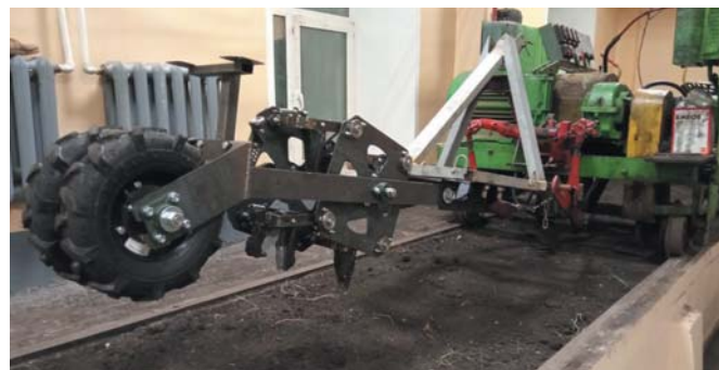
Рисунок 9. Испытания экспериментального образца посадочного аппарата в почвенном канале
