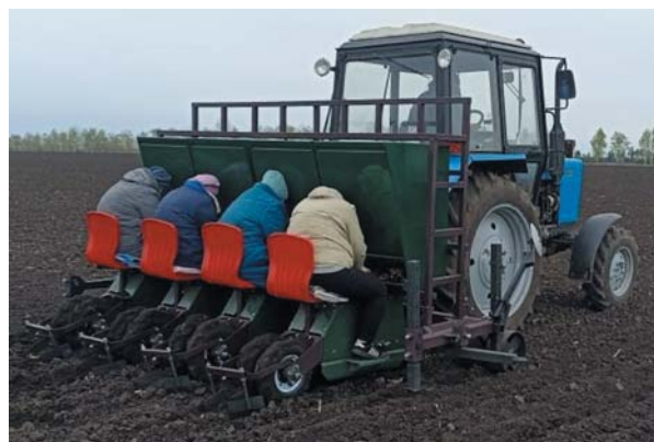
Рисунок 12. Полевые испытания опытного образца высадкопосадочной машины
