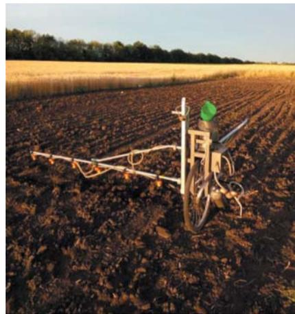
Фото 1. Опрыскиватель Агротоп
