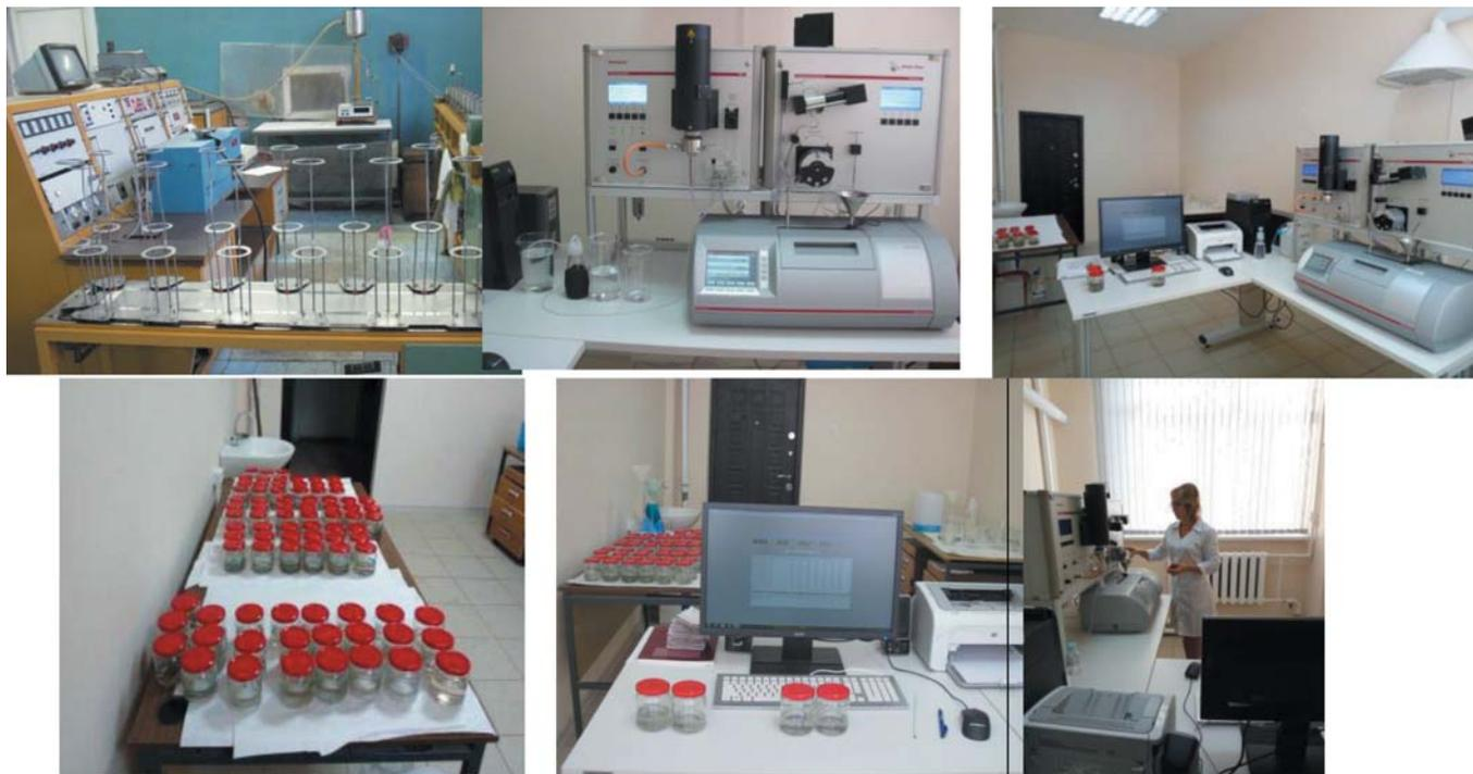
Получение дигератов из сахарной свеклы на линии Venema Automatic и определение технологических показателей корнеплодов анализируемых селекционных образцов на линии Betalyser
